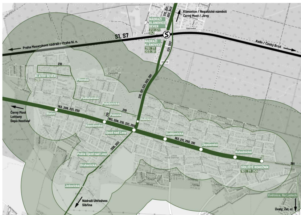
Obr. 39: Rozbor splnění parametrů docházkové vzdálenosti dle Dopravního plánu PID 2021-2025 [6]
